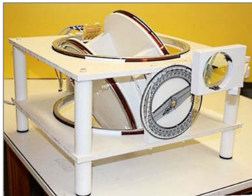
Fig. 2: Aparato para medir M en función del ángulo en pares de aprox. 300 mm de diámetro.
